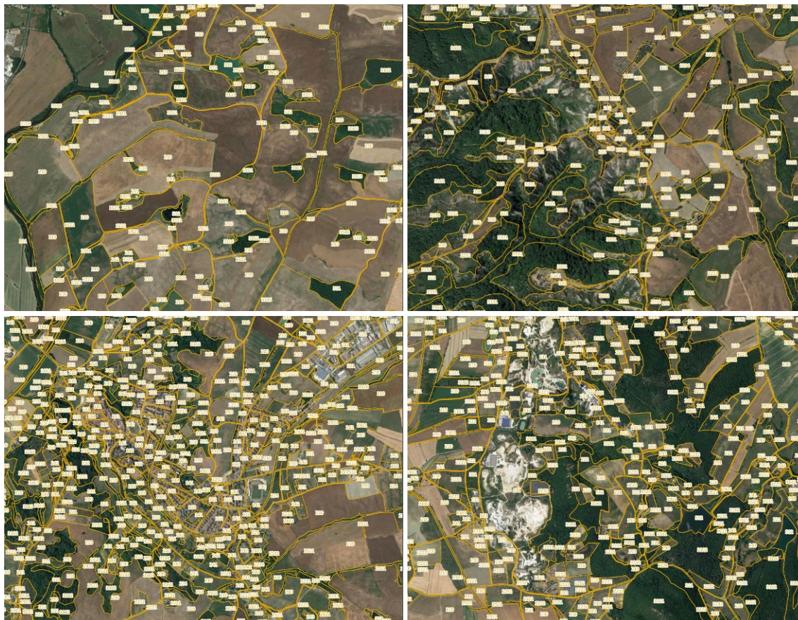
Figura 5. Un esempio del lavoro di fotointerpretazione condotto nell'aggiornamento dell'uso del suolo dell'ambito intercomunale di Asciano e Rapolano Terme: in alto l'aggiornamento dell'uso del suolo dell'ambito agricolo delle Crete di Camposodo (a sx) e quello inerente i calanchi di Chiusure (a dx); in basso l'aggiornamento dell'uso del suolo dell'abitato di Asciano (a sx) e quello inerente l'ambito estrattivo de Le Querciolaie (a dx)
