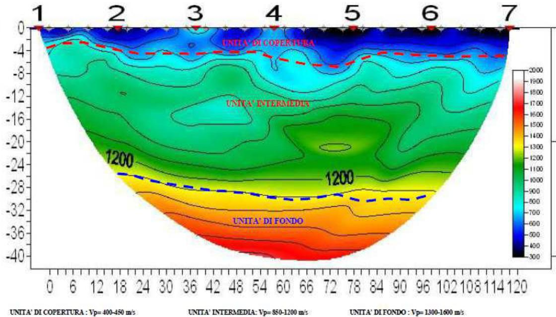
SEZIONE TOMOGRAFIA SISMICA ONDE SH - PROFILO 1
