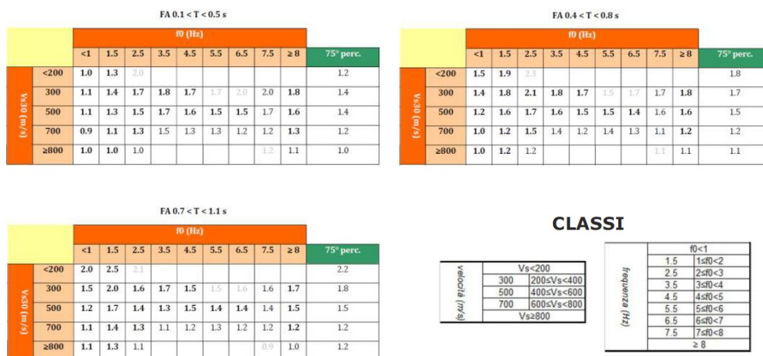
Figura 11 - Abachi di riferimento per la macro area Toscana Interna, per valori di a_g \geq 0,125g e profondità del substrato sismico maggiore di 30 m.
