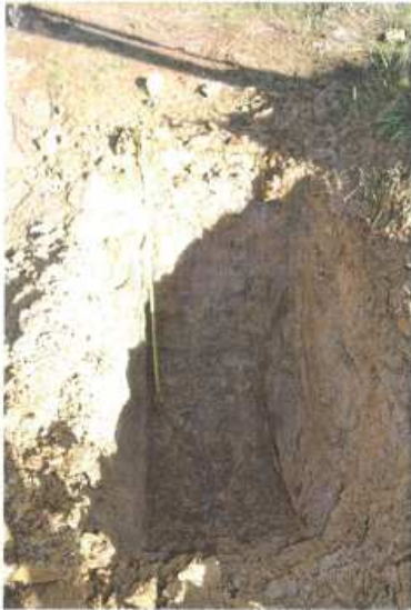
FOTO SAGGIO S1 – profondità 1.30 m da p.c.. Argille sabbiose consistenti
