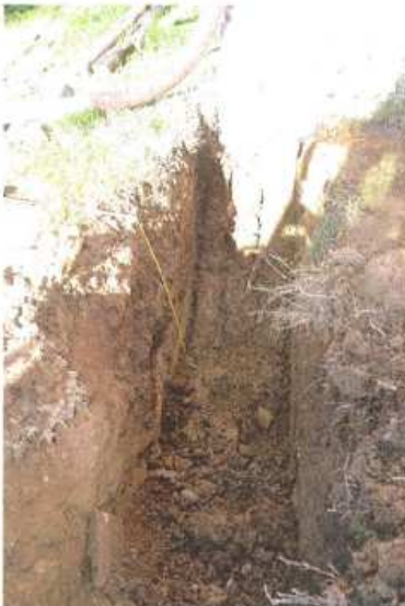
FOTO SAGGIO S2 – profondità 1.00 m da p.c.. Terreno di riporto: limi argillosi mediamente consistenti
