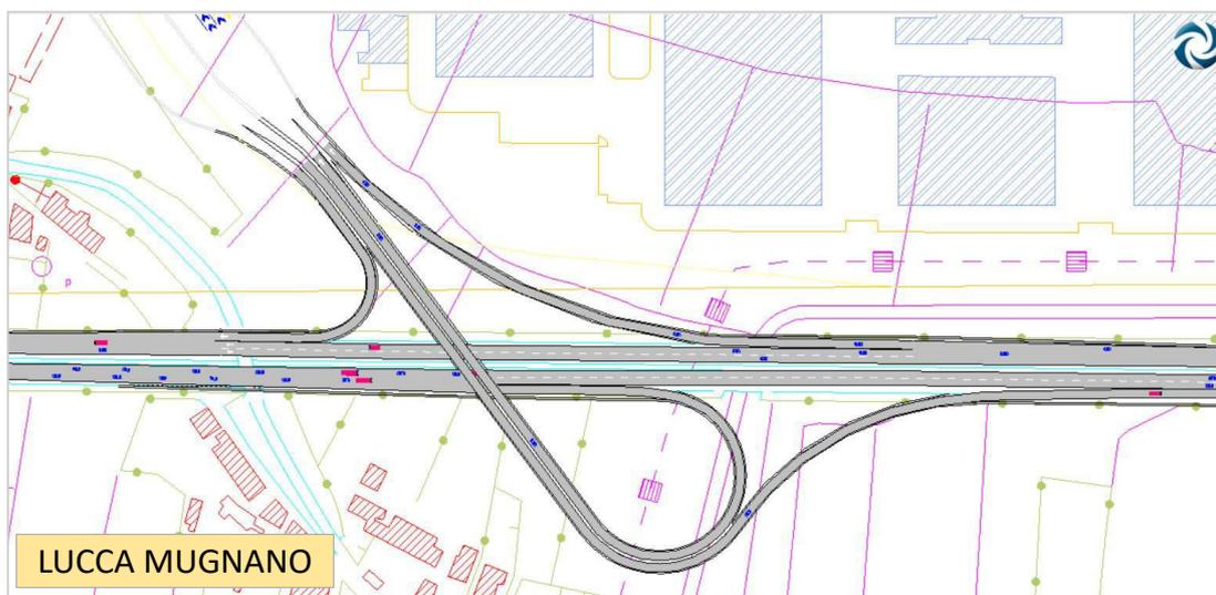
**Figura 42-** Dettaglio del modello su Aimsun in corrispondenza dello svincolo del Nuovo Casello Mugnano allo Stato di Progetto. In colore azzurro si distinguono gli autoveicoli, mentre invece i veicoli pesanti sono di colore rosa.
