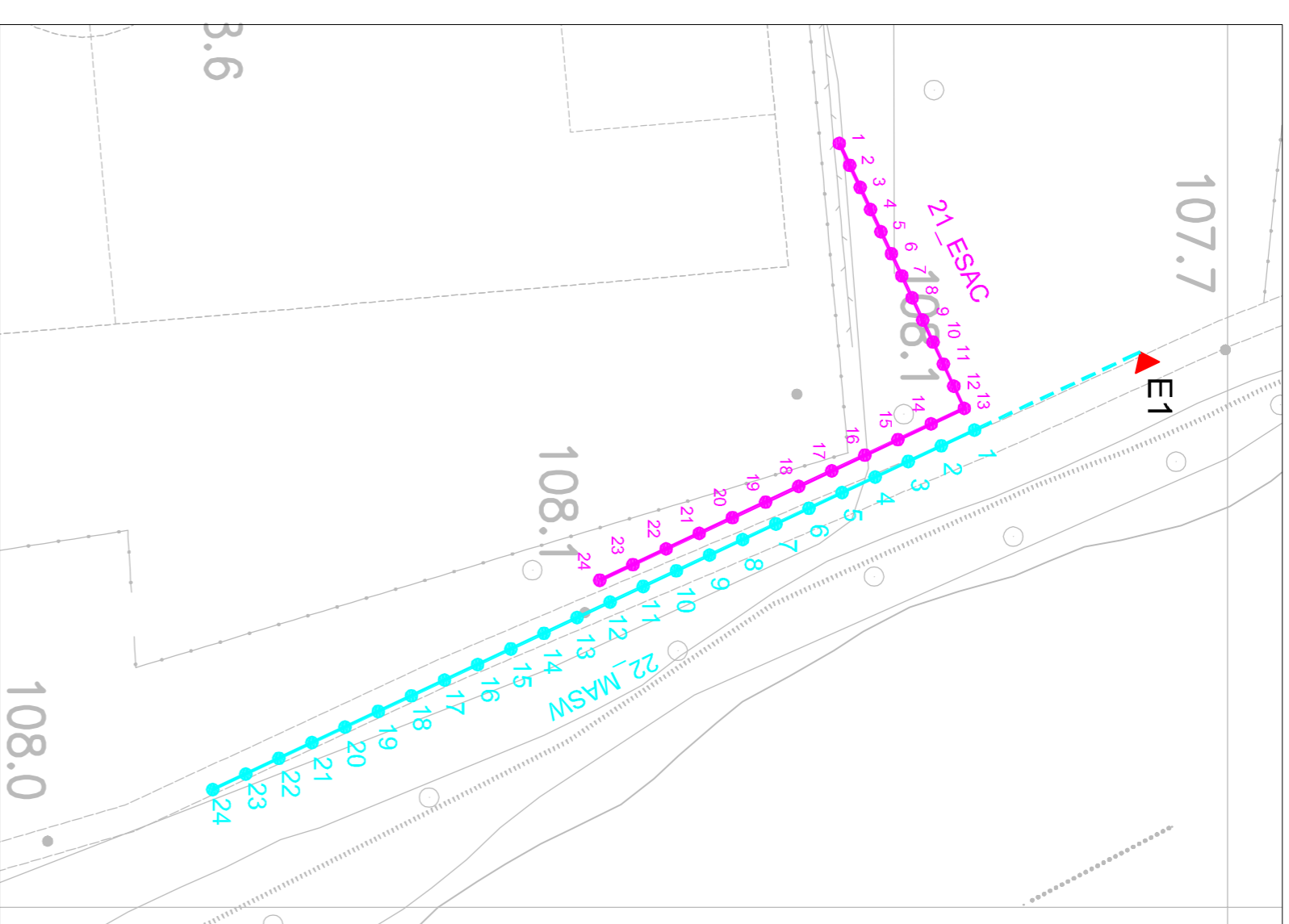
21_ARRAY SISMICO ESAC E 22_MASW - SCALA 1:500
