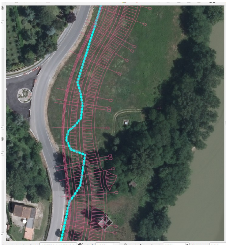
Immagine 1: in rosa argine cassa Leccio – in azzurro tratteggiato asse ciclopista fornita dalla progettista
